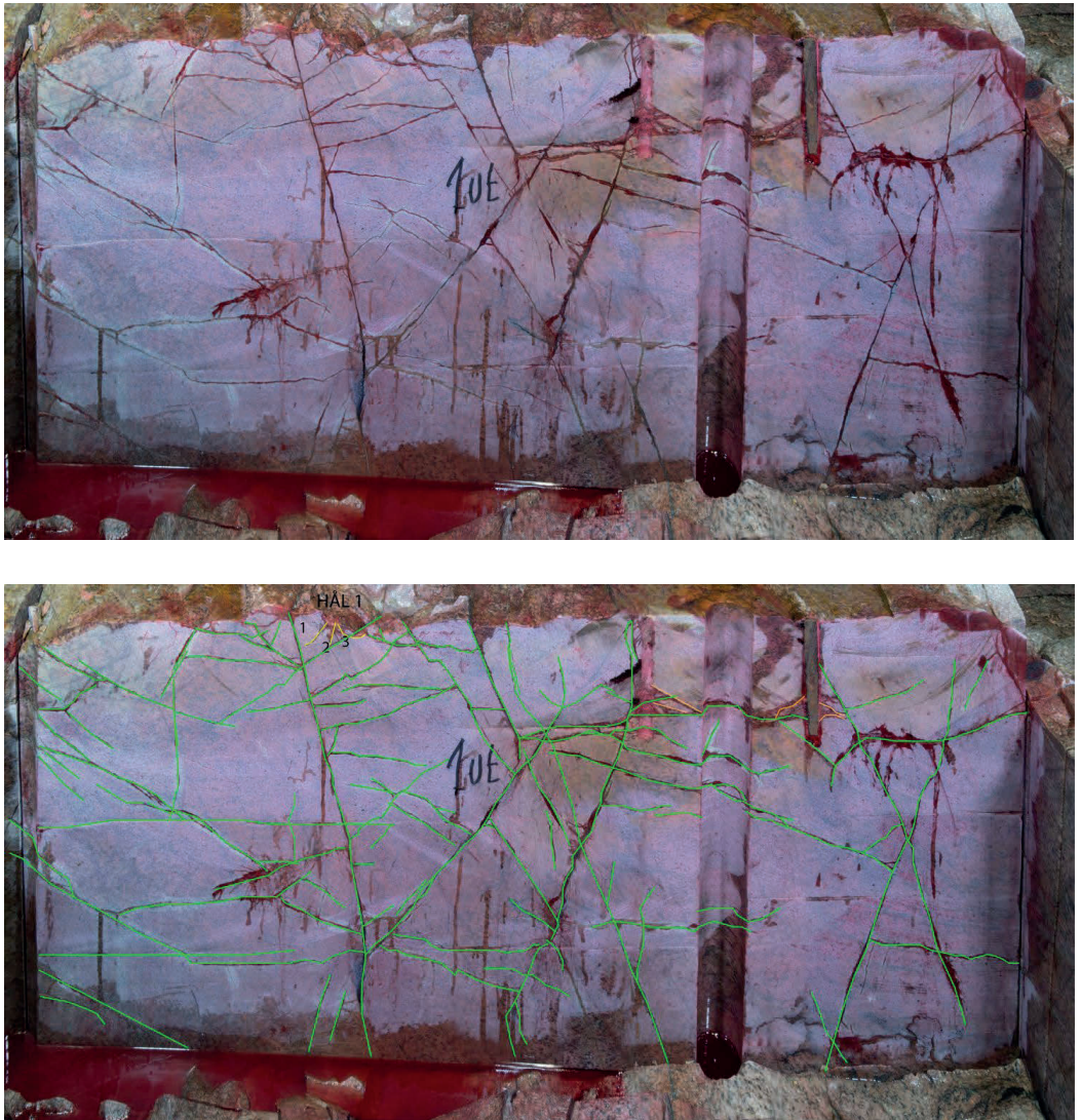
Figur 36. Snittytan TAS04, Sula sektion 25,5 ut med penetranter samt med inlagda spricktyper.
