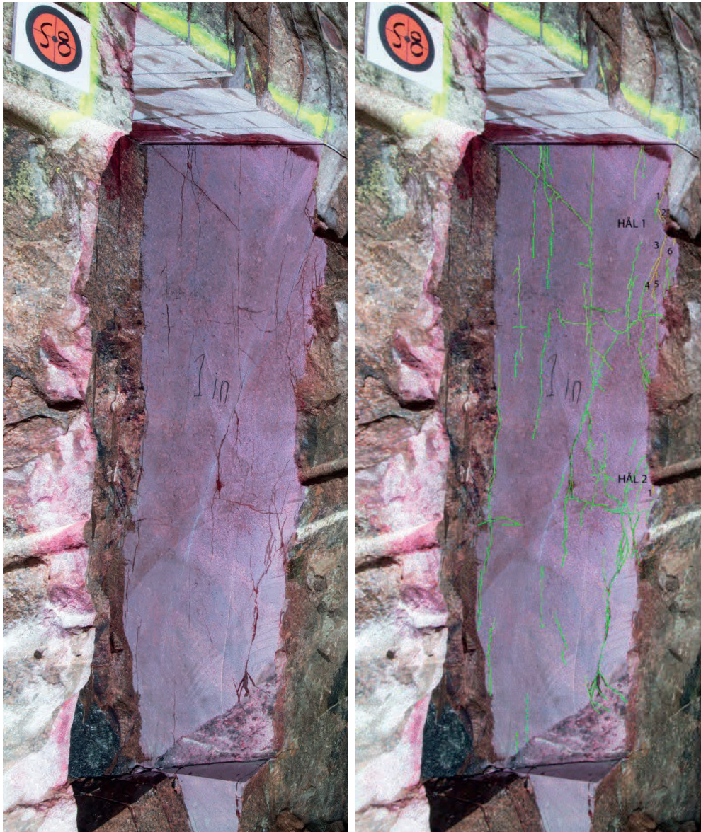
Figur 33. Snittytan TAS04, sektion 18 in med penetranter samt med inlagda spricktyper.
