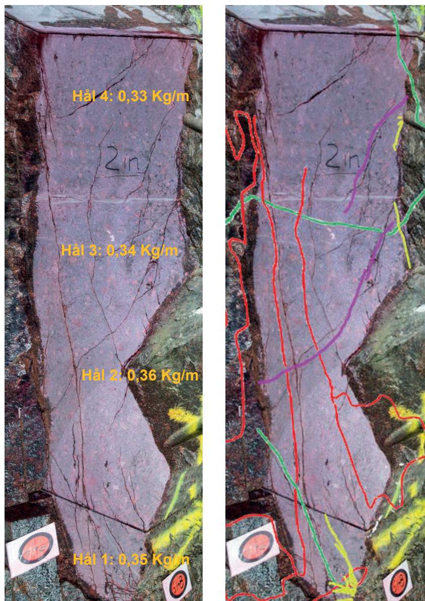
Figur 45. Snittytan TAS04, sektion 22 m riktning in med penetrantvätska samt tolkade spricktyper.
