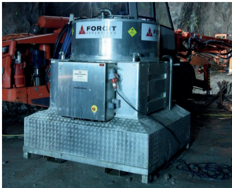
Figur 10. Forcit Laddenhet 201 och laddning med slangdragarenhet i TASJ.
