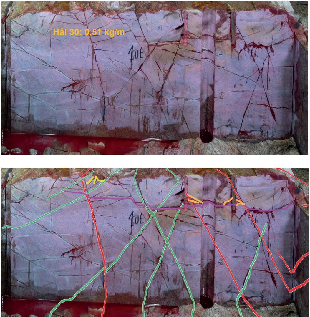
Figur 46. Snittytan TAS04, Sula sektion 25,5 m, riktning ut med penetrantvätska samt tolkade spricktyper.
