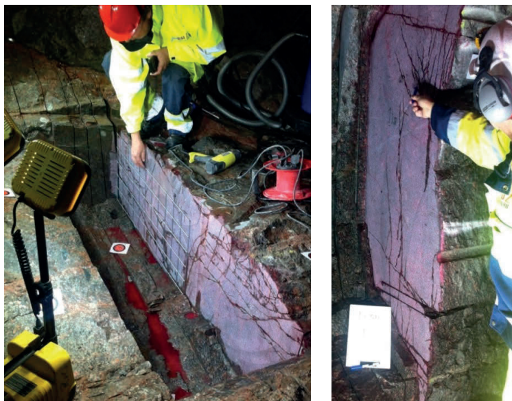
Figur 16. Kartering av sprängsprickor. TAS04, sektion 34 till vänster och sektion 13 i TASN till höger.
