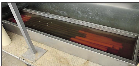
Figur 17: Preparering av GFRP bergbultar i 50^\circ\text{C} (provbultar i vatten representerar verkligt förhållande i fält)
