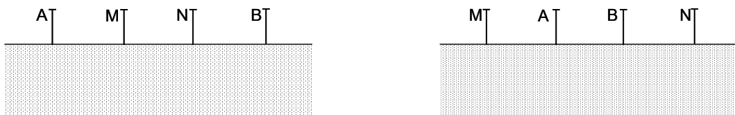
Figur 7. Normal (vänster) och reciprok (höger) Wennerkonfiguration.
