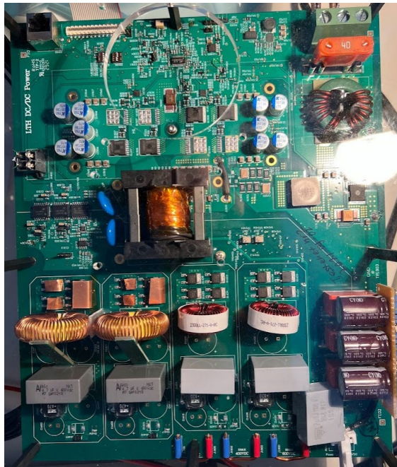
Figur 22. Foto på; a) labb-sändaren, och b) DCDC-omvandlaren till den stora sändaren.
