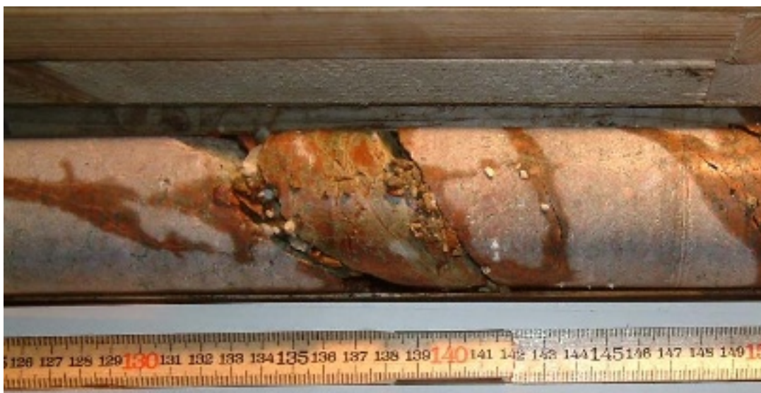
Figur 2. Borrkärnan från Borrhål KA2423A03 (jfr Figur 1) vid skärningen med den studerade deformationszonen (Ø 76 mm).
